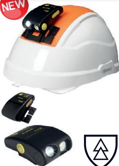
Allarme acustico prossimità di tensione il cui ritmo aumenta in base all'intensità del campo elettrico rilevato. Rileva la tensione dinamica: viene usata per silenziare l'allarme acustico, il dispositivo rimane in allerta e continua a misurare il campo elettrico. Il segnale acustico riprende automaticamente se l'intensità del campo elettrico rilevato aumenta.
