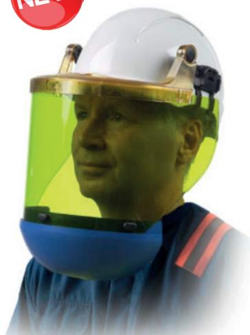
Il sistema protegge dai rischi di arco elettrico causati da guasti elettrici e testato secondo EN 166 e GS-ET-29. Schermi Green ArcPro con rivestimento anti-appannamento con mentoniera permanentemente fissata e montati su Hi-Tem 300 ArcPro Carrier. Adatto a tutti gli elmetti Centurion.
