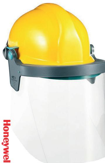
Aggancio con fascia elastica, si adatta ai più diffusi tipi di elmetto. I materiali resistono all'attacco di numerosi solventi, acidi e alcali. Resistente all'impatto (120m/s). Idoneo in metallurgia, industria chimica, costruzione. Adatto ai lavori di saldatura a fiamma se combinato con uno schermo oscurato. (Schermo a parte in acetato ART. BA.1002307, schermo ad arco elettrico ART.BA.1002308).
