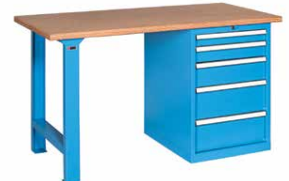
● RX 150 10 • l. 1500 / p. 700 / h. 865 • Portata 1400 kg. RX 200 10 • l. 2000 / p. 700 / h. 865 • Portata 800 kg. Banco da lavoro con cassettiera a 5 cassetti (1 H 75 mm.; 1 H 100 mm.; 1 H 150 mm.; 2 H 200 mm.) Workbench with chest of 5 drawers (1 H 75 mm.; 1 H 100 mm.; 1 H 150 mm.; 2 H 200 mm.) | Etabli d'atelier avec coffre à 5 tiroirs (1 H 75 mm., 1 H 100 mm., 1 H 150 mm., 2 H 200 mm.)
